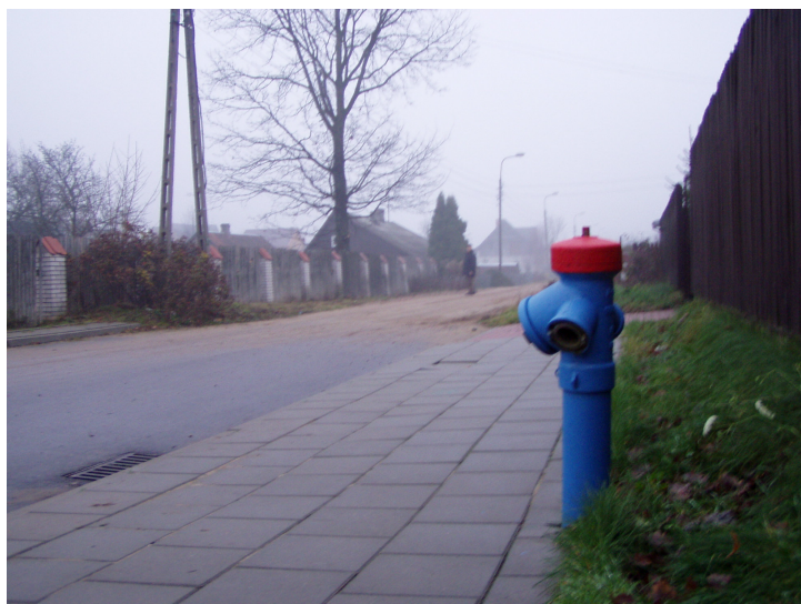
Fot. nr 16. Reper roboczy na hydrancie na skrzyżowaniu ulicy Sokólskiej i Polnej. Rzędna w najwyższym punkcie hydrantu H=150,304.
