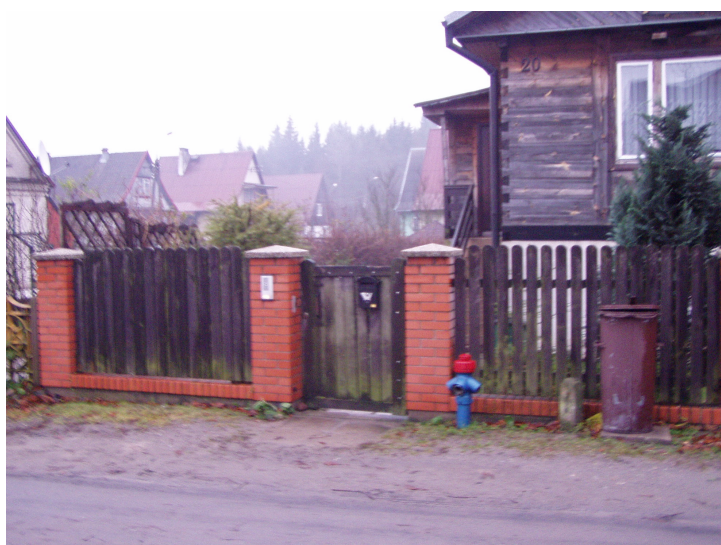
Fot. nr 15. Reper roboczy na hydrancie przy budynku nr 20. Rzędna w najwyższym punkcie hydrantu H=155,345.
