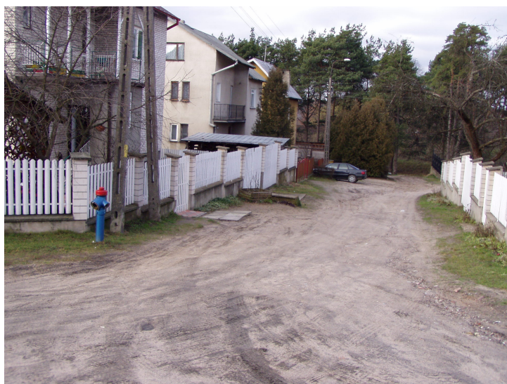
Fot. nr 20. Reper roboczy na hydrancie przy sięgaczu nr 4. Rzędna w najwyższym punkcie hydrantu H=155,595 .
