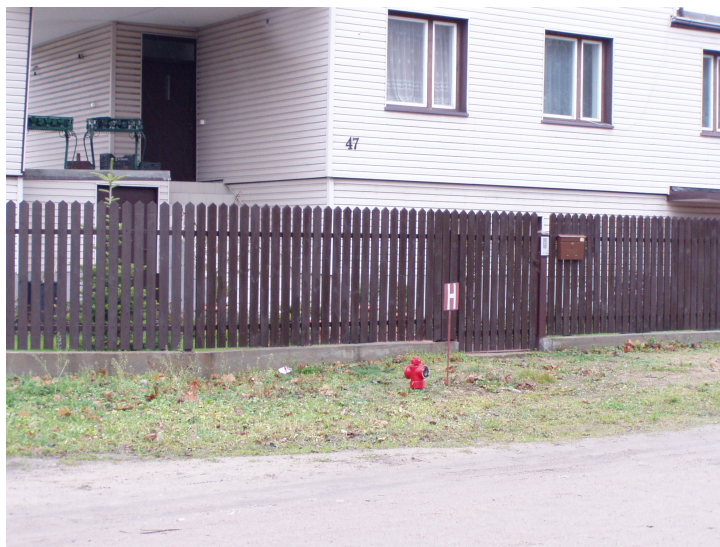
Fot. nr 5. Reper roboczy na hydrancie przy budynku nr 47. Rzędna w najwyższym punkcie hydrantu H=150,458 .
