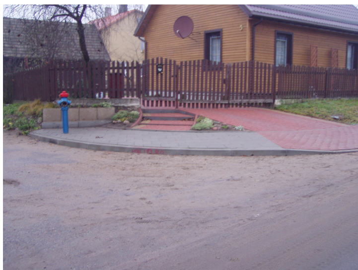
Fot. nr 17. Reper roboczy na hydrancie przy budynku nr 5 na skrzyżowaniu ulicy Sokólskiej z ulicą Dreszera. Rzędna w najwyższym punkcie hydrantu H=152,479.
