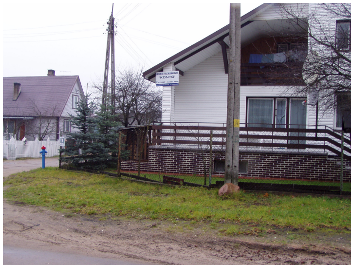
Fot. nr 8. Reper roboczy na hydrancie przy budynku nr 83. Rzędna w najwyższym punkcie hydrantu H=156,368 .
