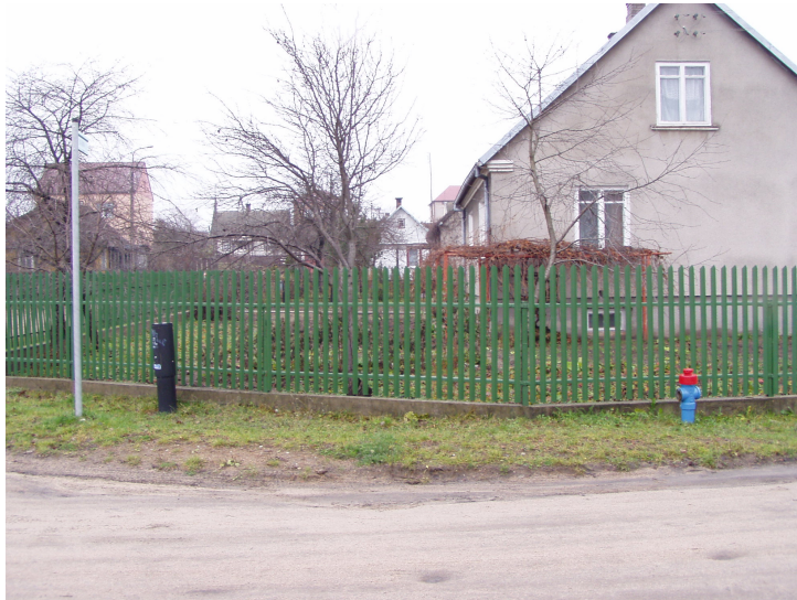
Fot. nr 4. Reper roboczy na hydrancie przy skrzyżowaniu ul. Orzeszkowej z ulicą Gęsią koło budynku nr 7. Rzędna w najwyższym punkcie hydrantu H=150,497.
